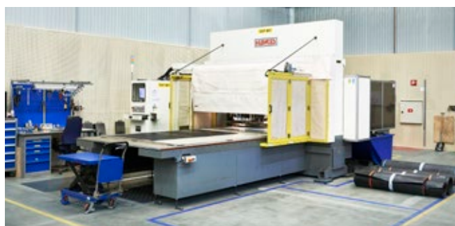
Genom en ljudabsorberande duk, precis intill där själva stansmomentet utförs, når minimalt med buller ut.
